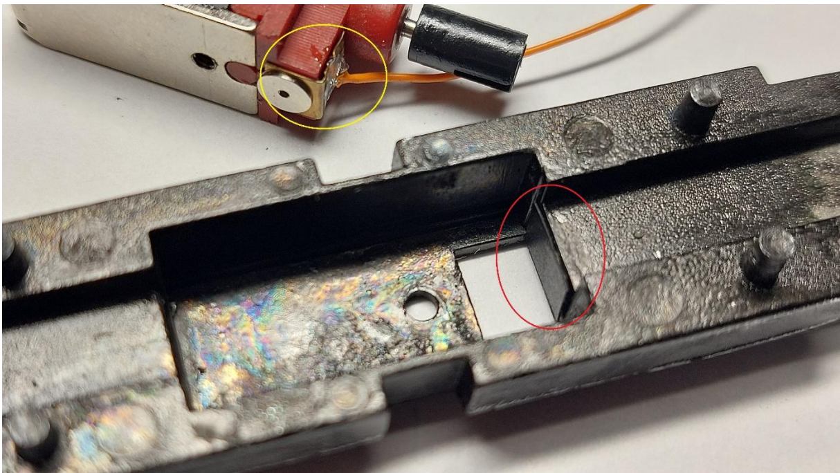
Bild 1: Motorkontakt mit Kabel und Chassis mit Isolation
